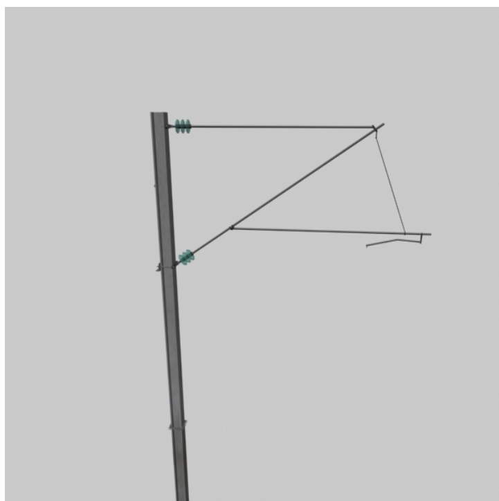
Console type 1C_D: console simple avec bras de rappel à droite
